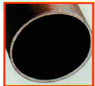
Dasselbe Rohr nach 6 Monaten der Arbeit des Apparates
